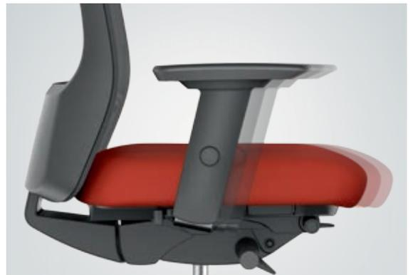
**Sincromeccanismo con regolazione del peso:** la rigidità dello schienale grazie al sincromeccanismo può essere regolata in sette livelli in base al peso.
